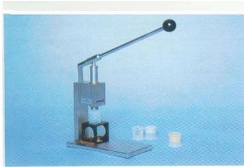
硬化後の樹脂がモールド型の内壁に固着して抜き出しにくい時に使用します。
